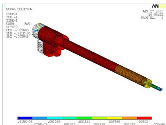
Fig. 4.10 Striker deformations upon hitting the primer
