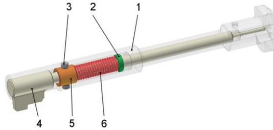
**Fig. 4.1 Striker mechanism**
